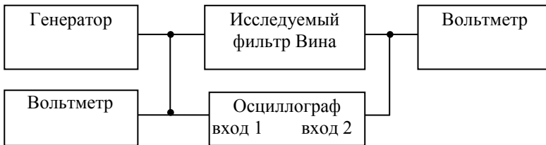
Рис.8.11. Блок-схема экспериментальной установки для измерения АЧХ и АХ фильтра Вина
