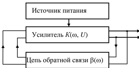
Рис.7.3. Представление генератора в виде усилителя с обратной связью
